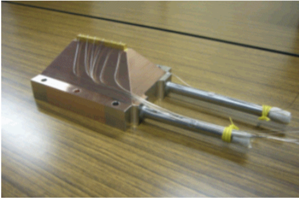
図 2-2：金標的と冷却ブロック
