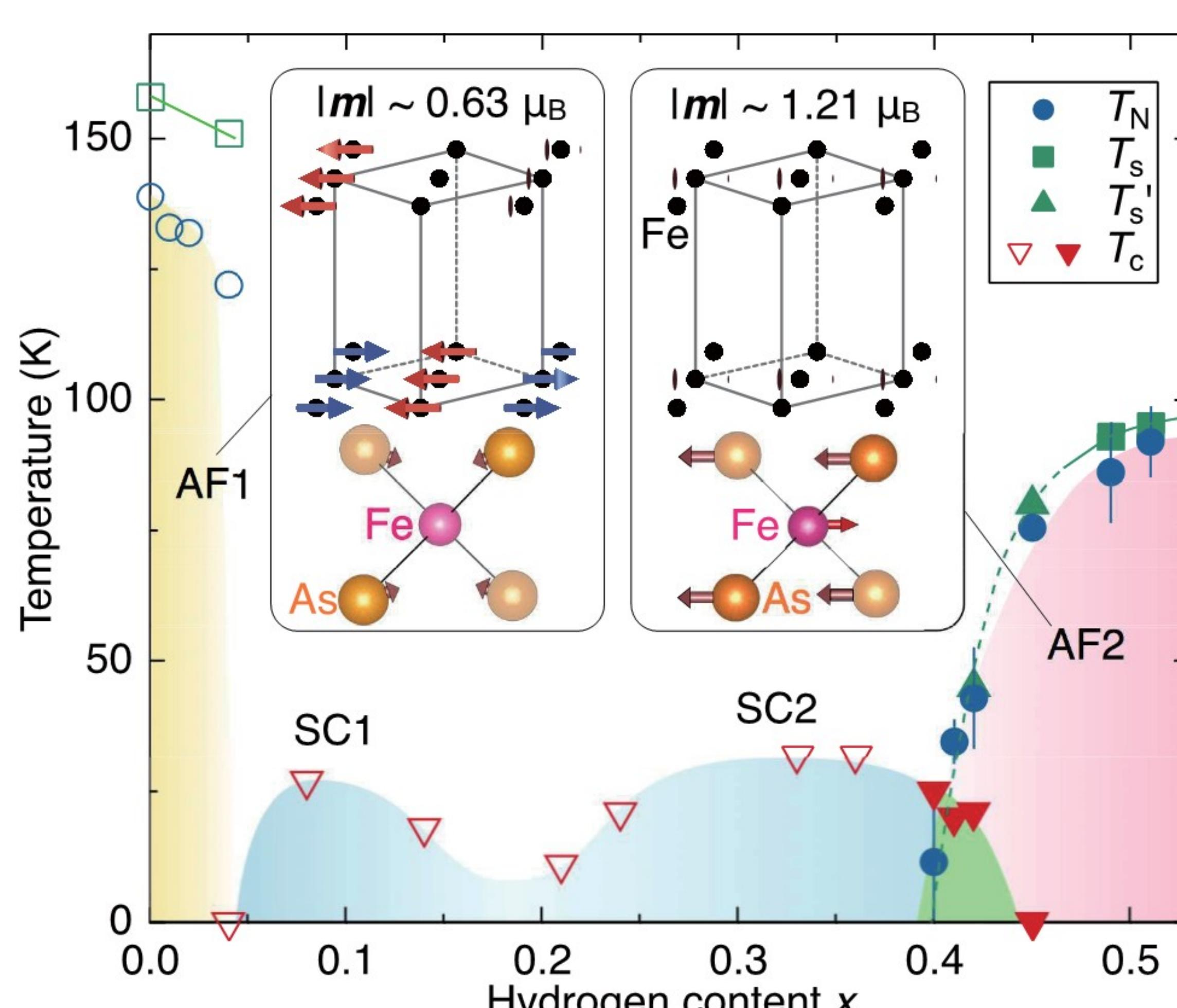
正ミュオンを用いて、鉄ヒ素系高温超伝導体の転移温度を上昇させるメカニズムの解明を目指して研究を行っています。酸素を水素に置き換えることにより、様々な磁気状態が現れ、転移温度も大きく変化することが分かりました。この結果はその後の研究の展開に大きなインパクトを与えました。
