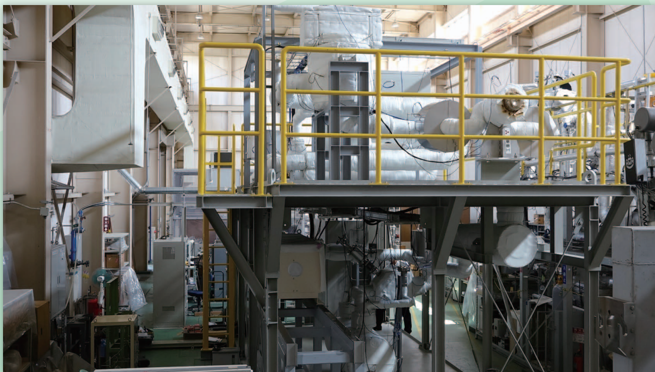
核破砕ターゲット模擬試験装置
