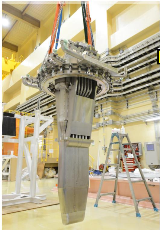
保管容器に収納した容器をターゲット台車に取り付け
