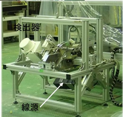
遠隔X線透過検査装置模擬体 →
