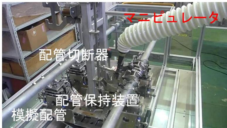
↑ モックアップ装置による切断・溶接工程検証試験
