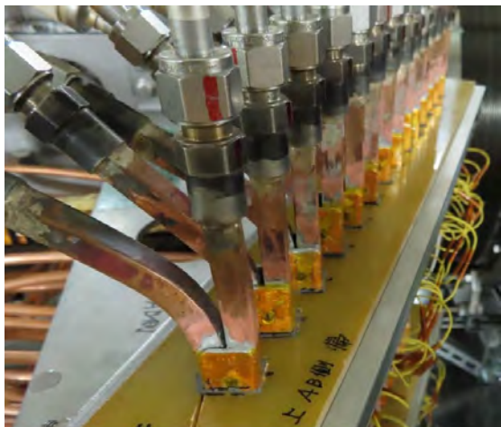
SM30A,30E,31A,32Aコイルを 半田と銅板(厚さ2mm)で補強
