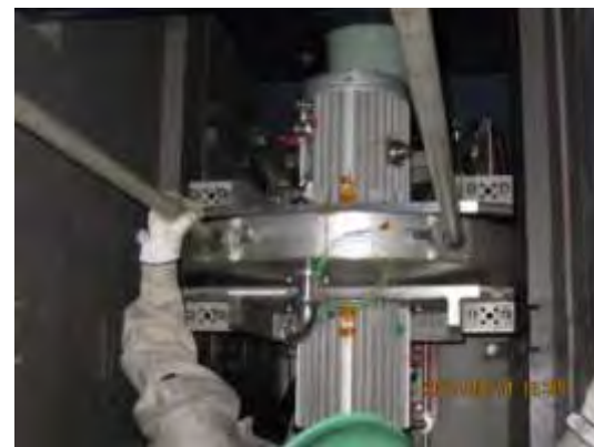
↑ 前置き遮蔽体解体後、高速ディスクチョッパーの健全性確認
