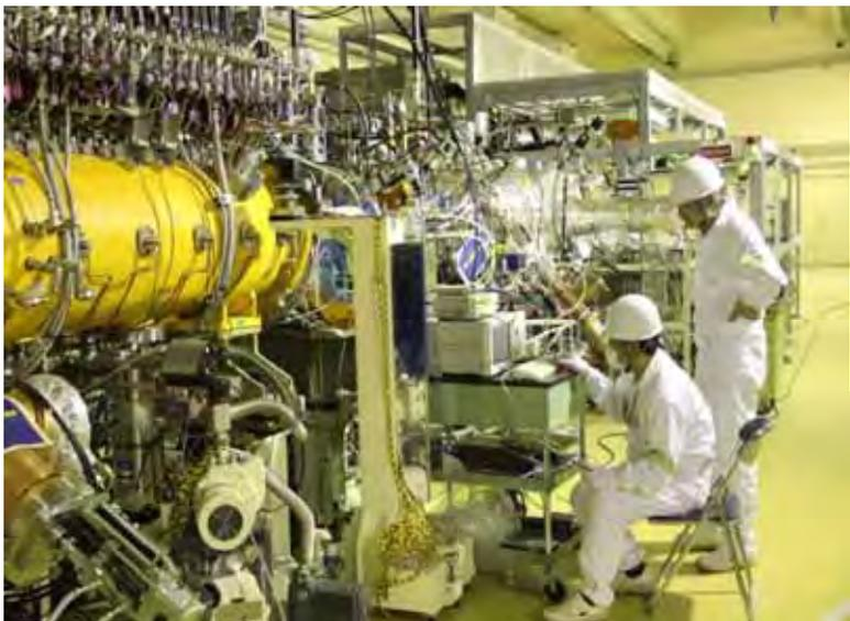
DTL1の低電力測定
