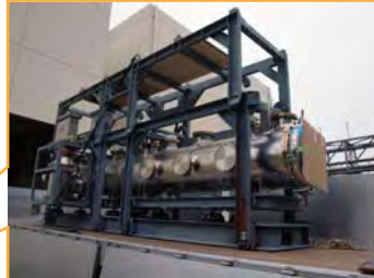
K1.8二次ビームラインの静電セパレータを取り出して装置全体を総点検
