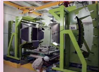
MLF 西側実験棟の沈下を復旧するため、実験装置等を一時撤去。写真は検出器等が取り外された BL19「匠」。
