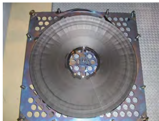
磁場中で加熱処理後の超高性能磁性体 (直径80 cm、厚さ2.5 cmのドーナツ形状)
