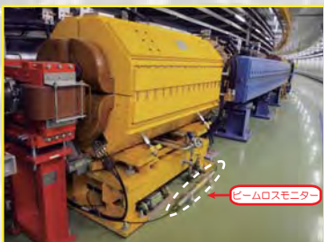
50GeVシンクロトロン内のビームロスモニターの動作性能試験を実施。
