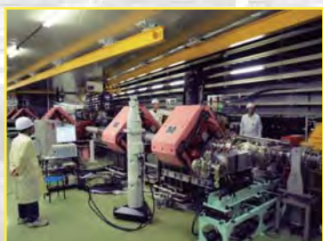
50GeVシンクロトロン入射部電磁石の精密位置測定とアライメント作業。
