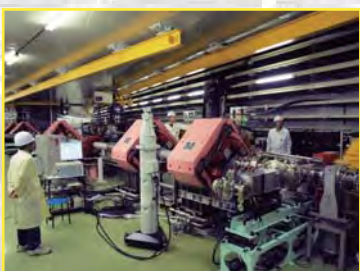
50GeVシンクロトロン入射部電磁石の精密位置測定とアライメント作業。
