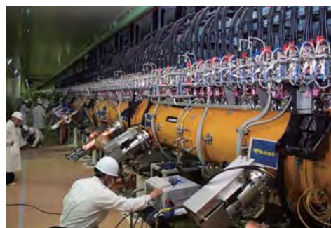
ドリフトチューブリニアックの調整作業
