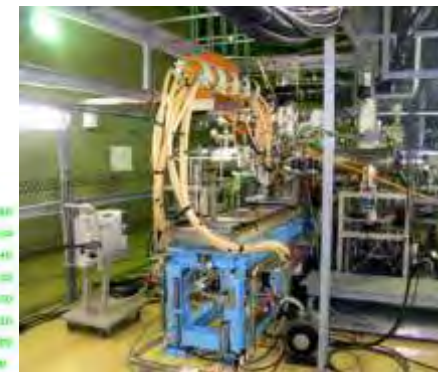
イオン源(上)と、調整運転の状況(左) 3時間運転で24mAに到達
