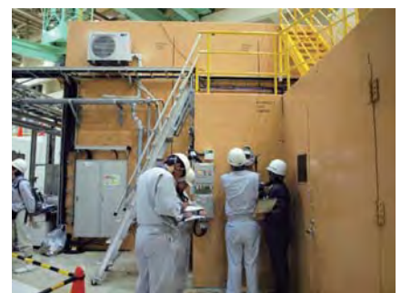
BL11 装置本体室外壁の空間線量率実測定
