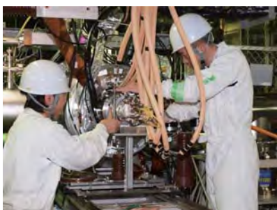
リニアックイオン源の交換作業
