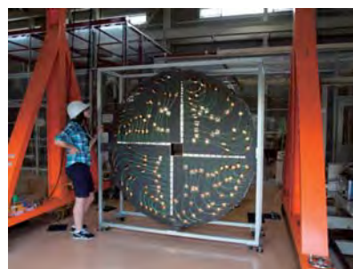
KOTO 実験に用いる荷電粒子検出器 (Charged Veto)
