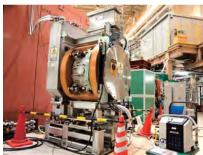
超低速ミュオンビームラインに設置する超伝導コイルの通電試験
