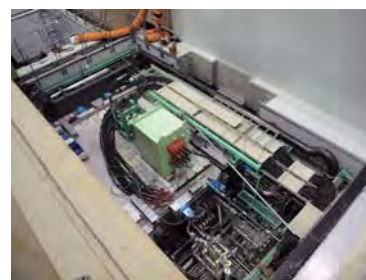
第1電磁ホーン関連機器調整作業 (ニュートリノ実験施設 TS)
