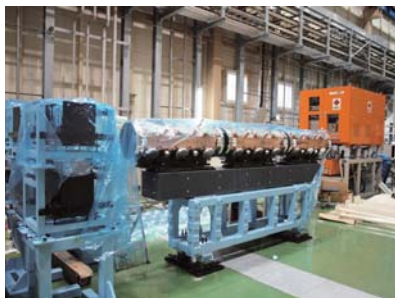
大電流高周波四重極(RFQ) (リニアック)
