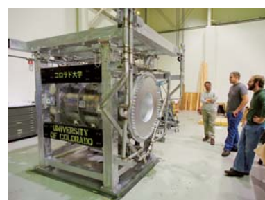
製作が完了した第2電磁ホーン予備機 (ニュートリノ関連、コロラド大学にて)
