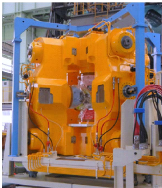
6軸型高压プレス, 圧姫(最大荷重500トン重/軸)
