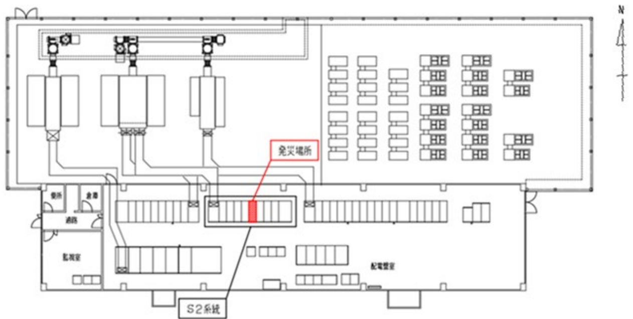
図3 50GeV 変電所内の高圧配電盤の設置
