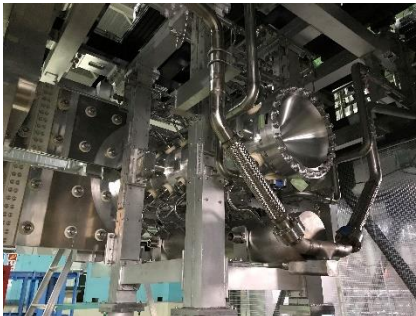
⑤ニュートリノビームライン電磁ホーン 所蔵: J-PARCセンター
