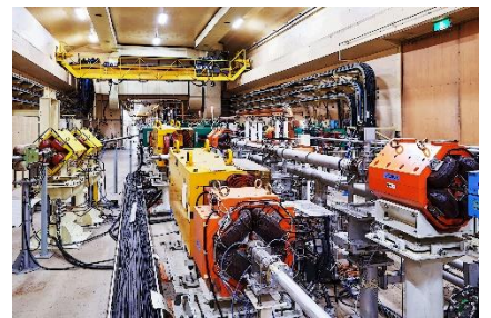
⑩電子・陽電子線形加速器からのビーム分岐ライン 写真提供: KEK
