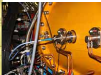
空洞のピックアップポートを使って低電力高周波の入出力を行い、ネットワークアナライザで測定
