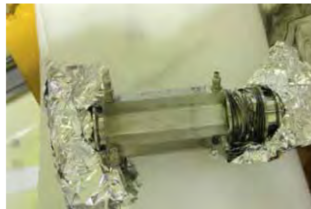
Q磁石の中から取り外したBPM(ビーム位置モニター)ベローが変形している。
