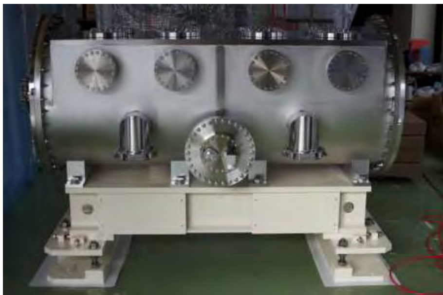
新・入射キッカーの真空 チェンバー(上)と、マグ ネット台座の組み立て (右)
