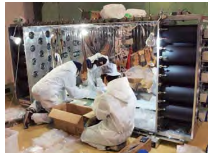
SKSスペクトロメータの粒子識別検出器の再調整 (K1.8実験エリア/ホール北側)
