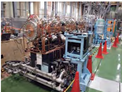
RFQ(高周波四重極加速空洞)2号機 (リニアック棟)
