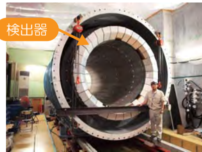
検出器(32 ユニット)を組み込んだ主バレル (ハドロン実験施設・KL ビームライン)
