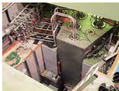
遮蔽ブロックを移動して二次粒子生成標的を交換(ハドロン実験施設)
