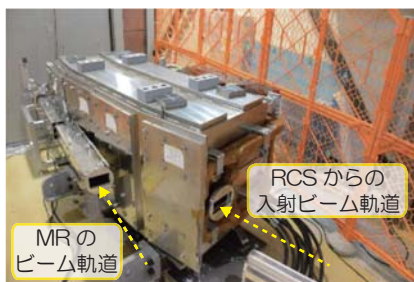
MRの ビーム軌道 試験中の新入射セプタム電磁石 (50GeV シンクロトロン: MR) RCSからの 入射ビーム軌道
