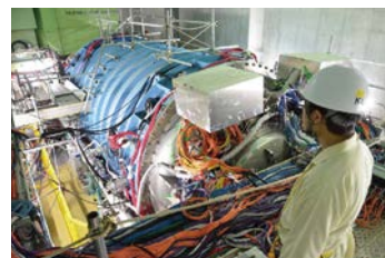
この装置で多数の中性K中間子の崩壊を観測しています。
