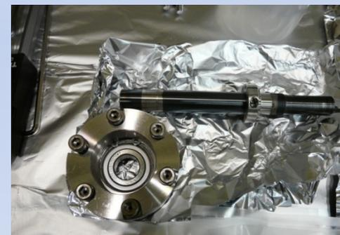
軸受寿命の確認(加熱回転試験)
