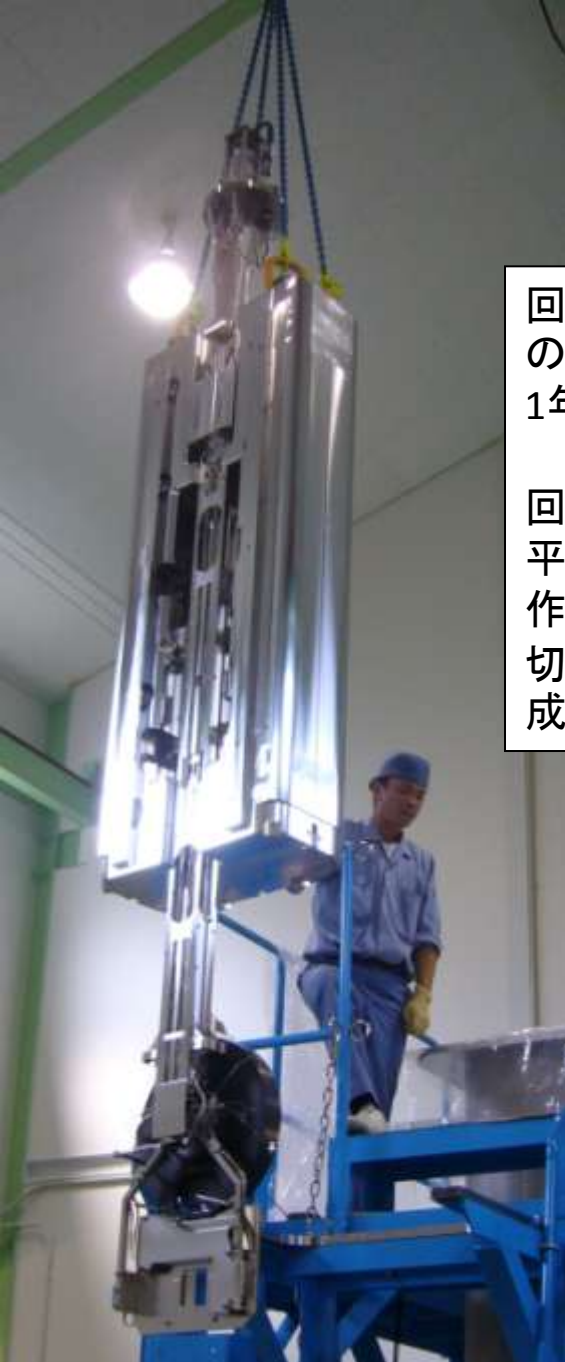
回転標的実機(製作工場)
