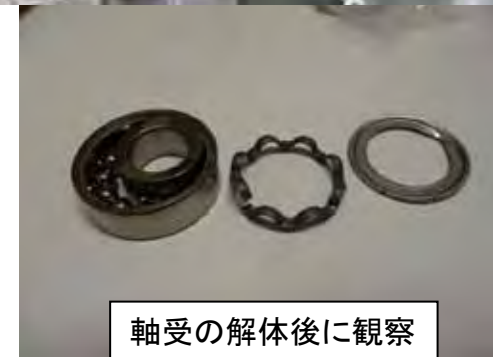
軸受寿命の確認(加熱回転試験)
