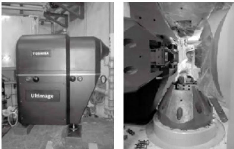
Fig. 1 (左) 中性子カメラ外観 (右) モックアップをマルチアンビル高压装置に設置した様子。
