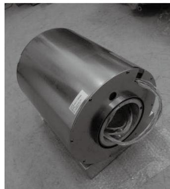
図 2 製作した磁気シールド
