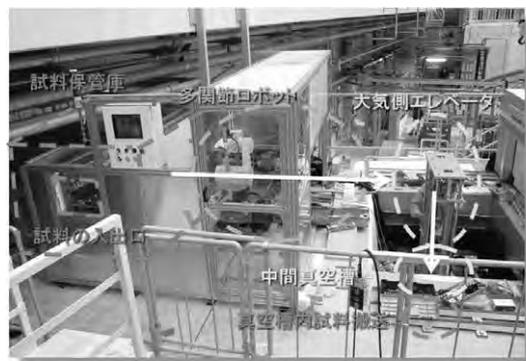
Fig. 1. 自動試料交換搬送機構
